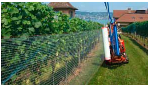
Maschinelles Verlegen von Überzeilen- und Seitennetz.
